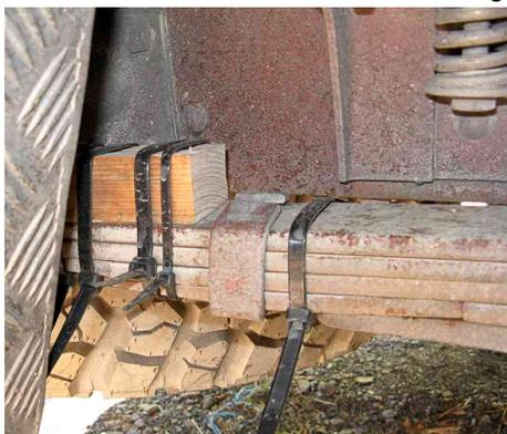
Horst entdeckt den Bruch eines Federblattes und fixiert den Schaden mit Kabelbindern. Dunkle Wolken stehen am Himmel, eine Windböe schleudert mir die Eingangstüre auf
