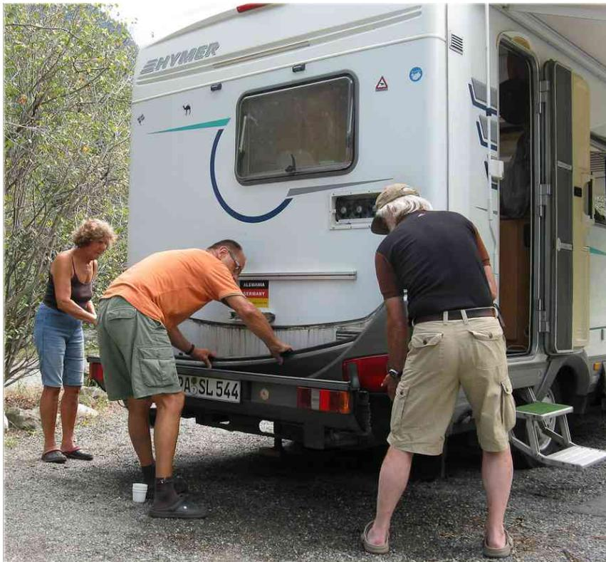
09.08.16 - Ruhetag, Wolken hängen an den Hängen, gelegentlich Regen. Am Nachmittag versuchen Horst und Willi den Gaskühlschrank von Willis Hymer zu reparieren. Dazu muss die hintere Stosstange abgebaut werden. Aber auch nach reinigen der Flammeinheit tut sich nichts und Teile zum Austausch der Düse haben sie nicht. Gegen Abend versuchen Willi und Horst von den umherliegenden Baumstämmen Stücke für das Feuer zu
